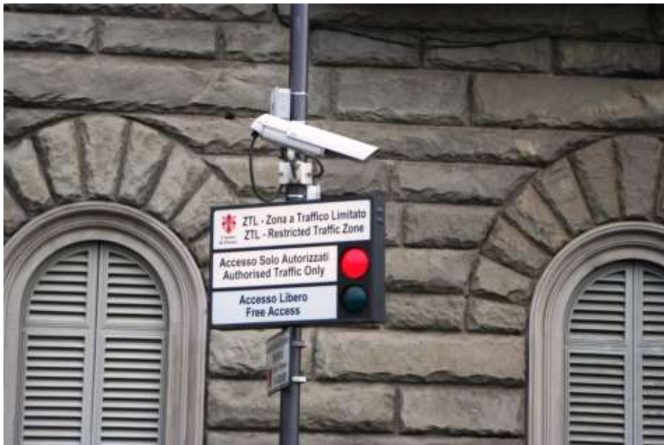
Figura 31 – Florença: Pormenor do Sistema de Acesso e Controlo a Zona de Tráfego Limitado
